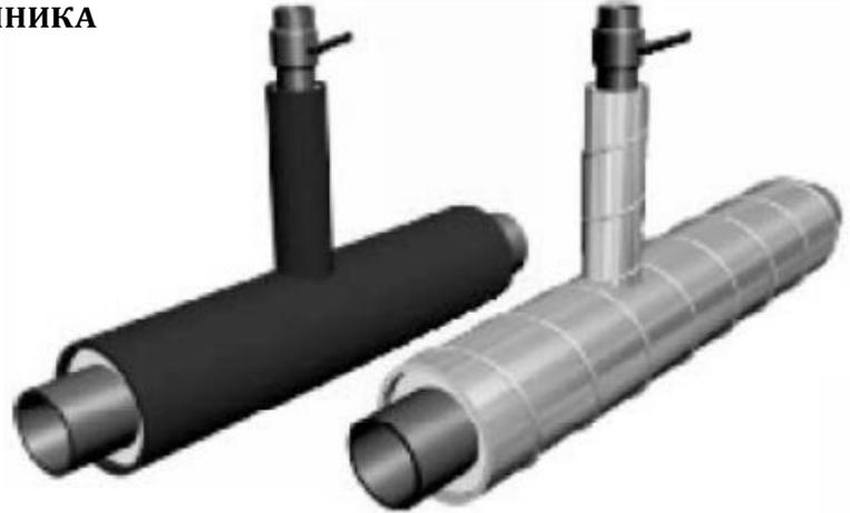
Тройник изолированный ППУ с шаровым краном воздушника устанавливается в верхней точке теплотрассы и служит для выпуска воздуха (стравливания воздушной пробки) из трубопроводной системы при ремонтных работах, а также при подключении и отключении системы теплоснабжения.
