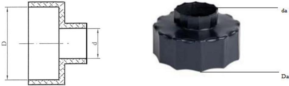
Термоусаживаемая заглушка изоляции предназначена для защиты теплоизоляционного материала от проникновения влаги.
