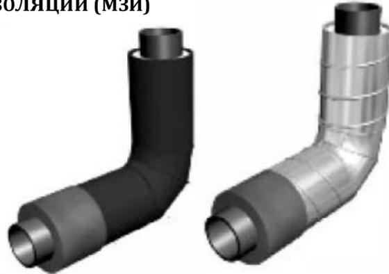
Для защиты ППУ изоляции и закольцованных проводов СОДК от внешних воздействий в месте окончания ППУ изоляции отвода устанавливается МЗИ длиной 215 мм. По требованию заказчика может быть установлена МЗИ длиной L. Крепление МЗИ к стальной трубе производится сваркой, герметизация стыка с полиэтиленовой оболочкой – термоусаживаемой лентой.
