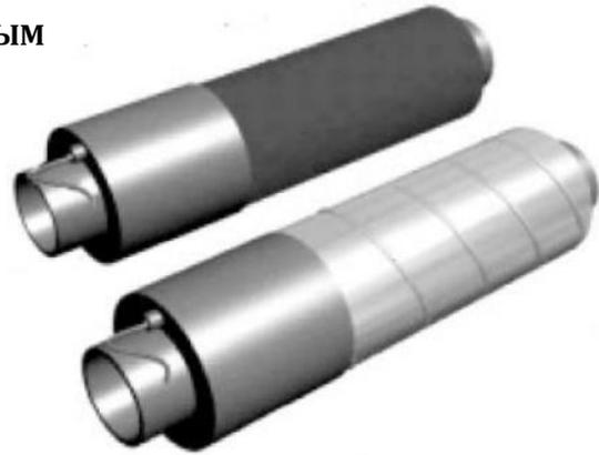
Концевой элемент трубопровода с МЗИ и торцевым кабелем вывода предназначен для соединения медных проводников, проложенных в теплоизоляционном слое пенополиуретана по всей протяженности определенного участка предварительно изолированного трубопровода к концевым терминалам системы оперативного дистанционного контроля. Устанавливается в тепловых камерах с ограниченным пространством.
