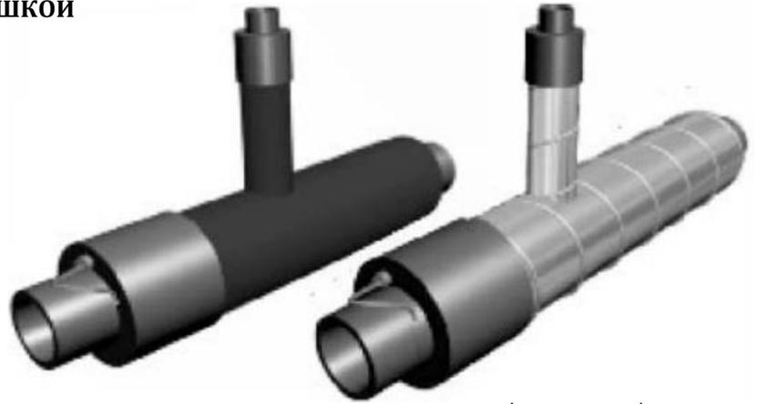
Тройник с МЗИ- изделие, предназначенное для присоединения к магистральному трубопроводу боковых ответвлений. Также устанавливается на границах перехода изолированной трубы на стальную. Кабель вывода служит для подключения к терминалам системы ОДК.
