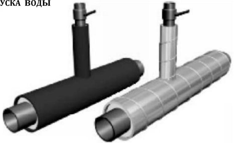
Тройники с шаровым краном для спуска воды в ППУ изоляции устанавливаются в тепловой камере в непосредственной близости от запорной и регулирующей шаровой арматуры участка трубопровода для осуществления подконтрольного обслуживающему персоналу процесса слива теплоносителя из системы при профилактических и ремонтных работах.
