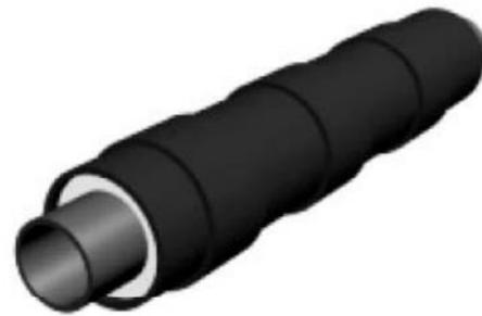
Труба бандажная в полиэтиленовой оболочке — это специальный вариант исполнения предизолированной трубы в полиэтиленовой наружной оболочке для подземной бесканальной прокладки. Применяются для прокладки на участках с повышенными нагрузками на поверхность ППУ трубопровода — под автомобильными дорогами и аналогичной инфраструктуры. Такие трубы прокладываются в стальных защитных футлярах большего наружного диаметра, которые дополнительно защищают стальную трубу от давления грунта и транспорта.
