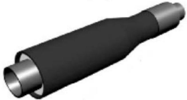
Переход с МЗИ – соединительный элемент трубопроводов разных диаметров. Металлическая заглушка изоляции служит защитой от проникновения влаги и возможного механического повреждения на рабочем участке при временной приостановке работ. Также устанавливается на границах перехода изолированной трубы на стальную.
