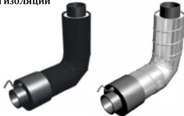
Отвод с МЗИ и кабелем вывода – фасонное изделие, предназначенное для плавного изменения направления трубопровода, а также для герметичного соединения медных проводников всего трубопровода. Медные провода соединены между собой во всех изделиях в непрерывную цепь посредством терминалов системы ОДК через кабели вывода, которые вмонтированы в торцевую часть металлической заглушки изоляции.
