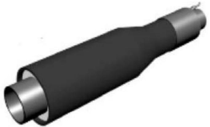
Переход с МЗИ и кабелем вывода – соединительный элемент трубопроводов разных диаметров. Кабель вывода служит для соединения медных проводов всего трубопровода. Медные провода соединены между собой во всех изделиях в непрерывную цепь, с терминалами системы ОДК через кабели вывода, которые смонтированы в торцевую часть МЗИ.
